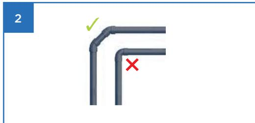
Se si desidera installare curve a gomito nella condotta di scarico, utilizzare 2 curve a 45° anziché un'unica curva a 90°.
