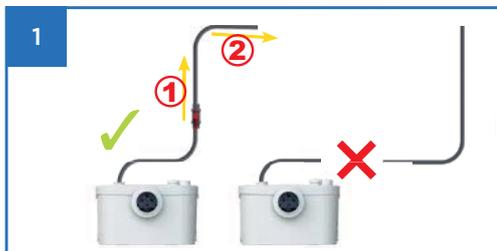
La condotta di scarico deve essere posata in verticale verso l'alto già nella parte anteriore (1). **A partire dal punto più alto della condotta (2) è necessaria una pendenza di almeno l'1%.**
