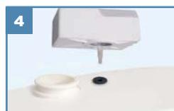
Fissare il dispositivo Sanialarm all'apertura del tubo.
