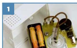
Inserire nell'alloggiamento 2 batterie AAA (da 1,5 V, non fornite in dotazione).
