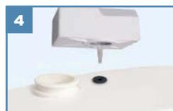
4 Befestigen Sie den Sanialarm an der Rohröffnung.
