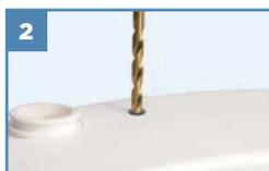
2 Bohren Sie an der auf der Geräteabdeckung angegebenen Stelle ein Loch mit einem Durchmesser von 10 mm.
