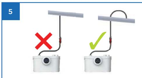
Die Abwasserleitung der Hebeanlage muss **von oben an das Fallrohr angeschlossen werden und in Abflussrichtung verlaufen.**
