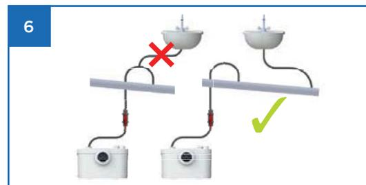
Sanitärgegenstände **dürfen nicht an die Druckleitung der Hebeanlage angeschlossen werden.**
