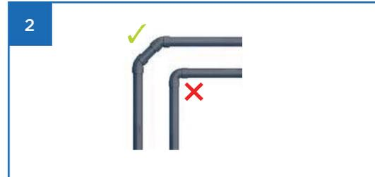
Wenn Sie Winkelstücke an der Abflussleitung anbringen möchten: Verwenden Sie 2 Teile mit 45°-Winkeln anstelle von einem Teil mit einem 90°-Winkel.
