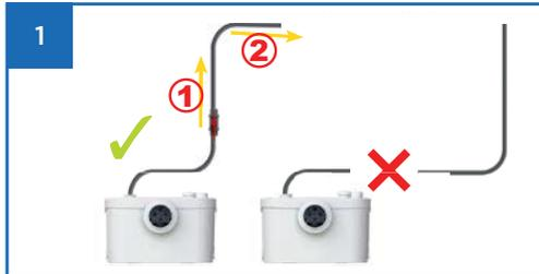
Die Druckleitung muss bereits im vorderen Teil vertikal nach oben geführt werden (1). **Ab dem höchsten Punkt der Leitung (2) ist ein Gefälle von mindestens 1 % erforderlich.**
