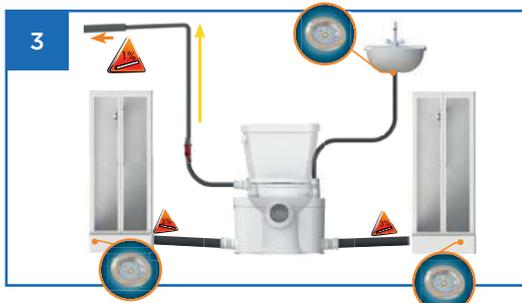
**Sorgen Sie für ein Gefälle** zwischen den Sanitäranlagen und der Hebeanlage von SFA.
