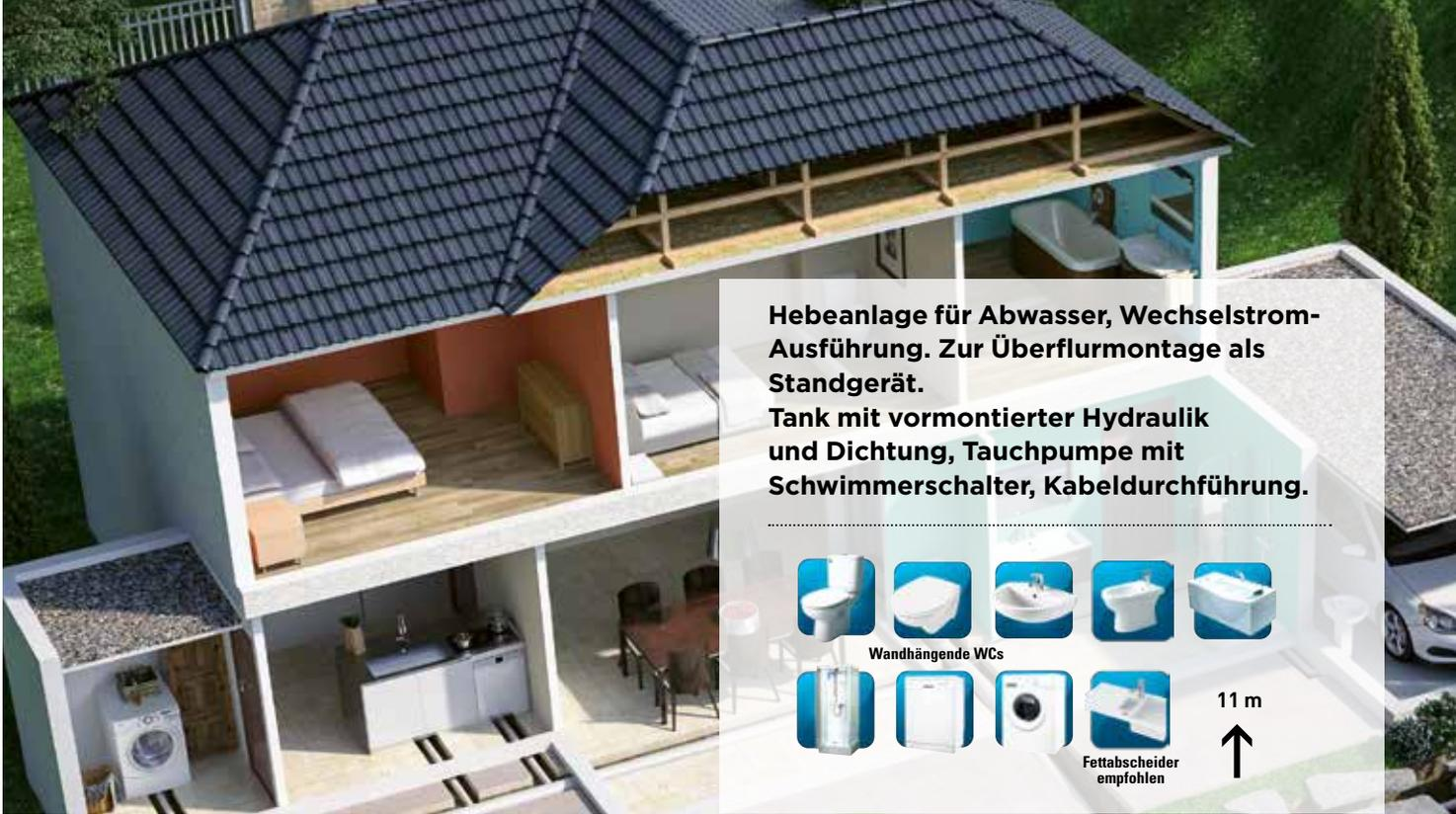
**Hebeanlage für Abwasser, Wechselstrom-Ausführung. Zur Überflurmontage als Standgerät.**
