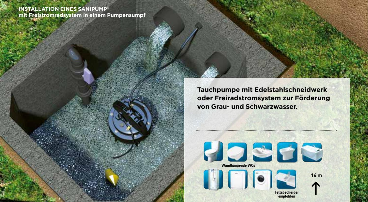
**Tauchpumpe mit Edelstahlschneidwerk
